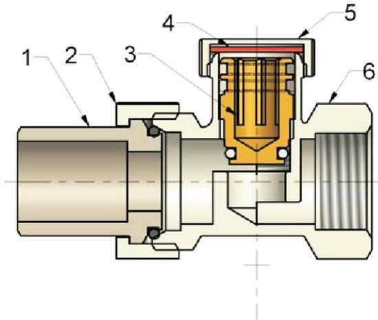
В латунный корпус „6” клапана встроена головка клапана „3” с двойным уплотнителем, что гарантирует повышенное наружное уплотнение в каждом положении головки клапана. Головка клапана имеет шестиугольное углубление для шестигранного ключа S-8 с помощью которого клапан закрывается или открывается и устанавливается предварительная настройка клапана.
